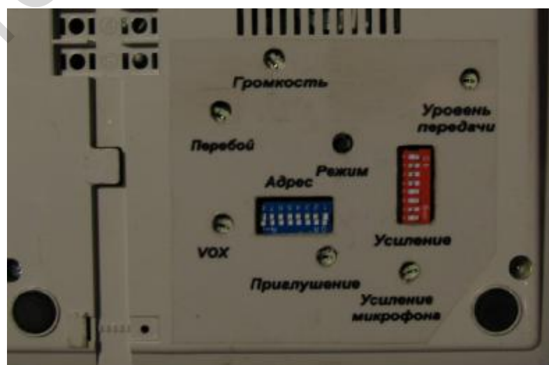
Рисунок 1.2 – Расположение регулировок в основании СДС “Диалог-64”
