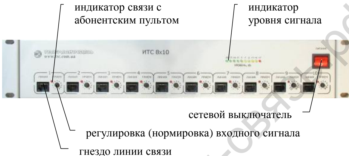
Рисунок 1.1 – Лицевая панель блока ИТС 8x10
