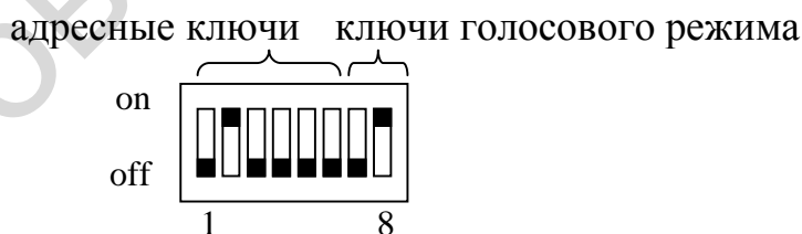
Рисунок 2.1 – Установка адреса и голосового режима
