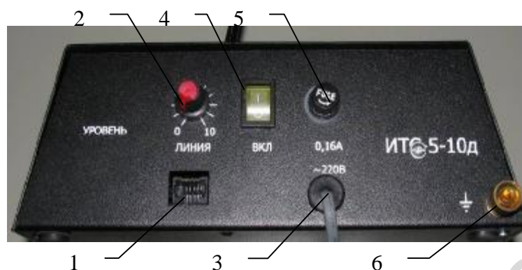
Рисунок 1.2 – Задняя стенка настольного пульта ИТС
